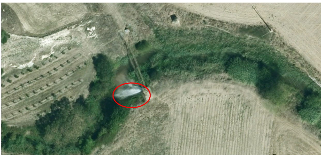
Figura 2. Vista aerea (02/2007) dell'attraversamento pensile: in rosso è evidenziata la perdita che ha eroso la sponda
