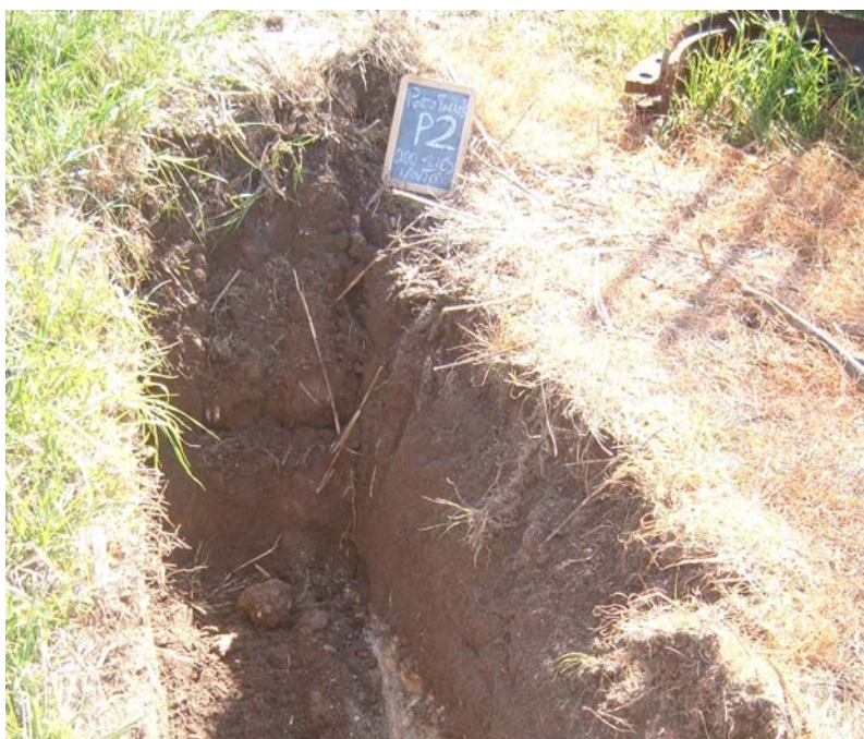
Figura 7. Pozzetto P2: particolare del contatto tra suolo e calcarenite.
