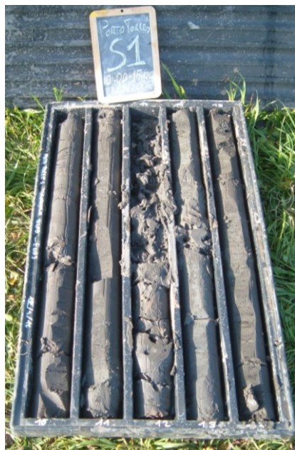
Figura 13. S1: limi sabbioso-argillosi rinvenuti oltre i 10 metri di profondità
