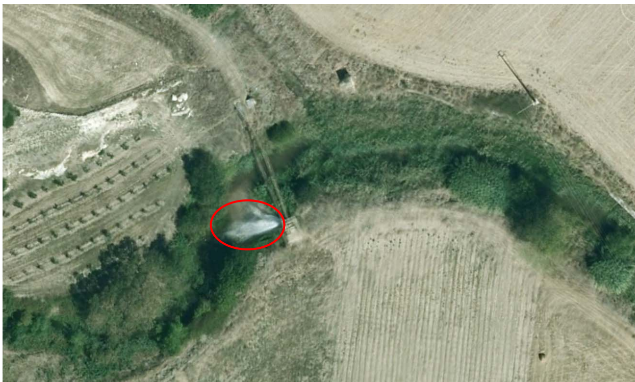
Figura 2. Vista aerea (2007) dell'attraversamento pensile: in rosso è evidenziata la perdita che ha eroso la sponda.
