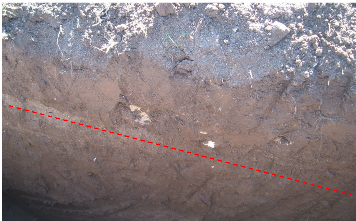
Figura 12. Particolare della sezione di scavo del pozzetto P1: si osservano i primi decimetri sciolti e rimaneggiati dall'attività agricola e, in parte, riportati a creare un argine in destra idraulica.
