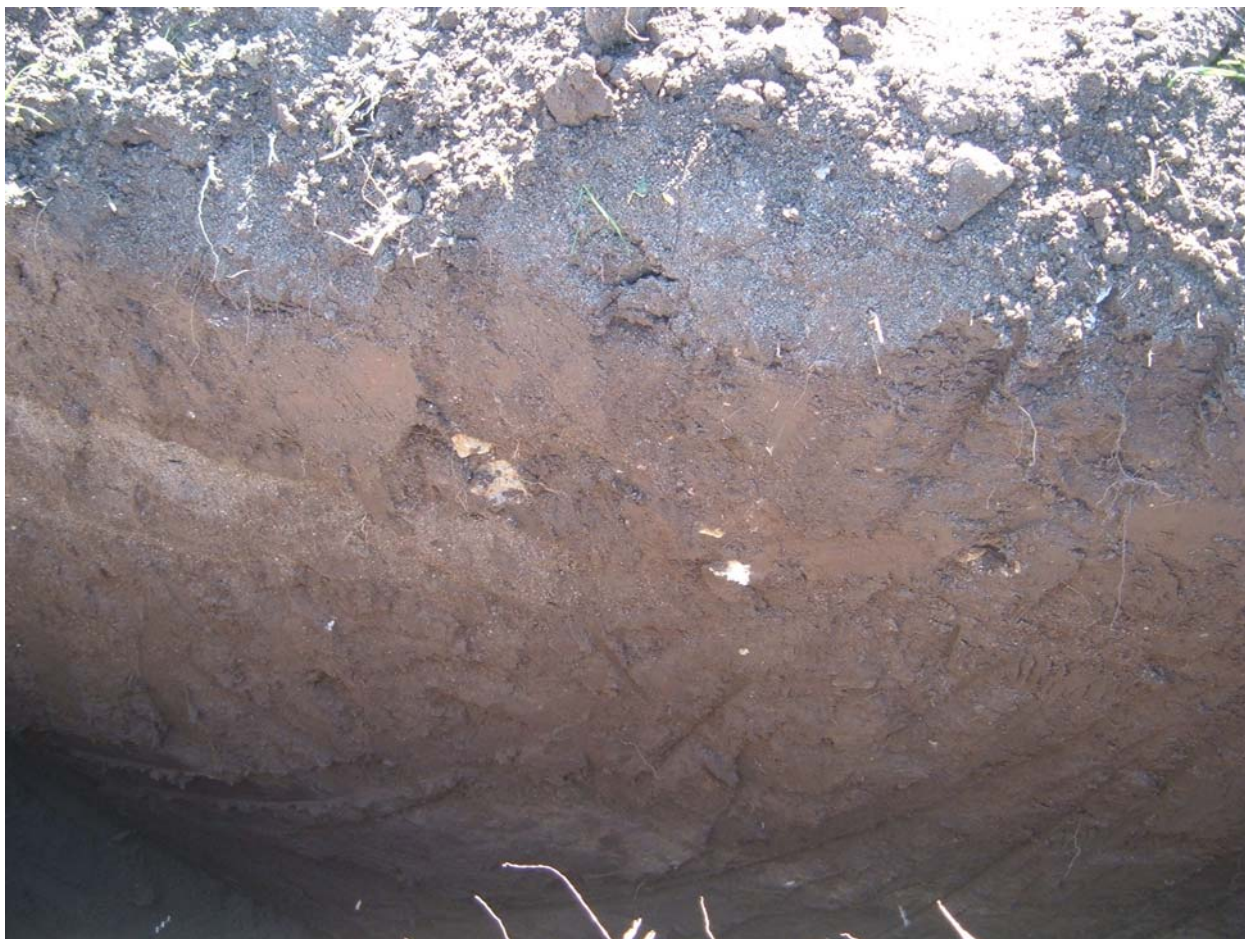
Figura 6. Particolare della sezione di scavo del pozzetto P1: si osservano i primi decimetri sciolti e rimaneggiati dall'attività agricola e, in parte, riportati a creare un argine in destra idraulica.
