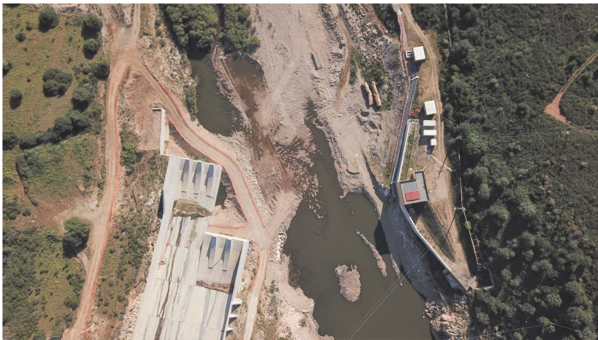
Vista dall'alto del salto di sci e della centrale idroelettrica
