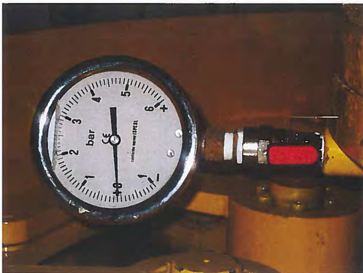
Foto III-1 - Centrale di S. Lorenzo - Misura della pressione a valle della girante (13/06/08, ore 07:40 circa)
