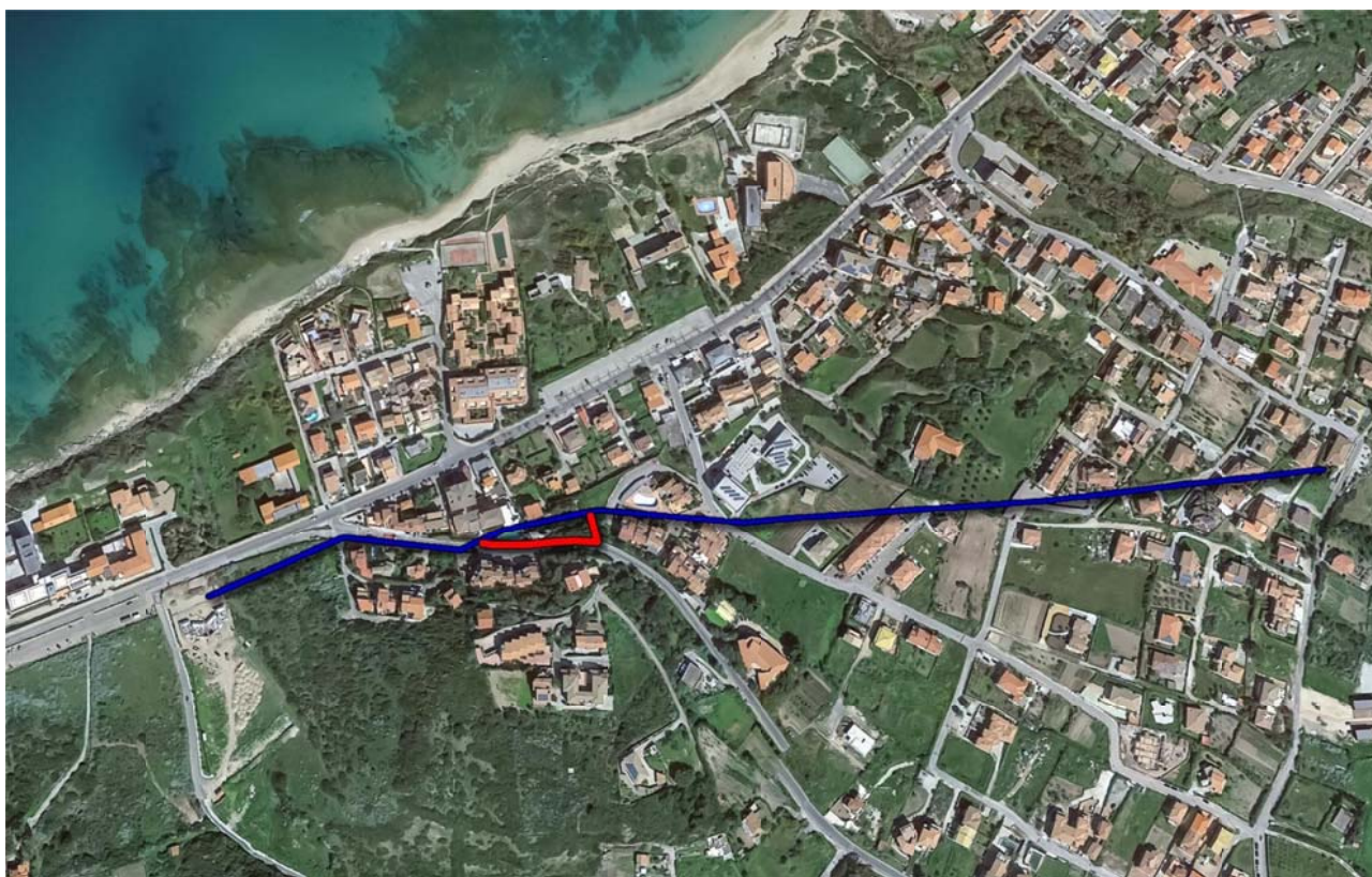
Figura 1. Ortofoto del centro di Lu Bagnu con il tracciato della condotta esistente (in blu) e quello in progetto (in rosso)
