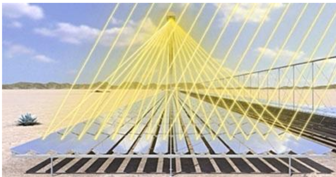
Figura 8 – Schema di funzionamento di un collettore solare a concentrazione con specchi Fresnel (Fonte: Novatec Solar).
